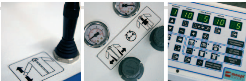
Programmatore per le varie funzioni di stiro oltre a regolazioni manuali Programmer for pressing functions besides manual adjustments
